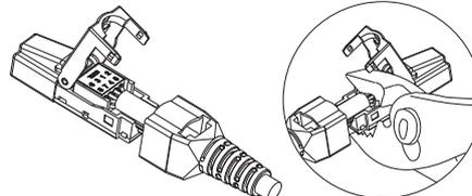
⑥ Steckerabdeckung schließen und sicherstellen, dass der Beidraht einen guten Kontakt zum Gehäuse hat. Knickschutztülle über den Stecker schieben und mit Kabelbinder fixieren.
