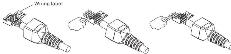
④ Place wiring cap on plug.
