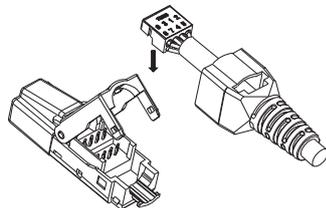
⑤ Konfektionierten Kabelmanager auf Stecker positionieren und mit einer Zange fixieren bis dieser einrastet und eine sichere Verbindung gewährleistet.
